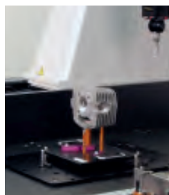
K551218: Applicazione della piastra sul pallet ricevitore
